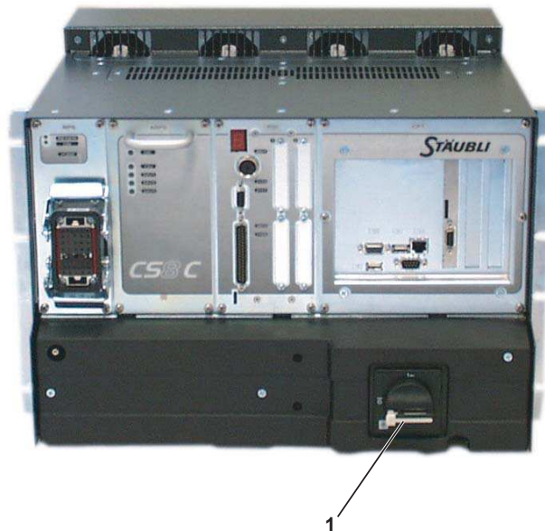
Rysunek 2: Widok szafy sterowniczej ze sterownikiem CS8C do manipulatora Stäubli TX60L, 1 – załączanie urządzenia [2].
