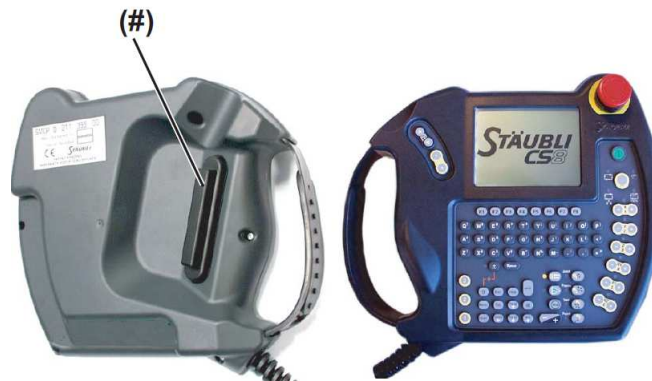
Rysunek 3: Panel sterowania ręcznego – MCP (Manual Control Panel), (#) – trópołożeniowy przycisk zezwolenia na pracę ramienia [2].
